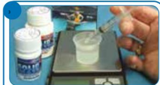
Dokładnie odważyliśmy na wadze 5 g żywicy.
