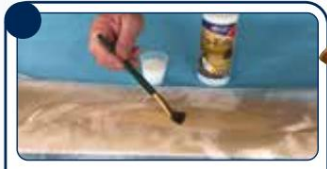
Następnie Eze-Kote jest szczołkowany przez tkaninę z włókna szklanego. Należy pamiętać, że niewykorzystany Eze-Kote można zwrócić do pojemnika.
