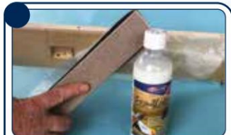
Nadmiar tkaniny można łatwo odciąć za pomocą bloku szlifierskiego Perma-Grit lub papieru o ziarnistości 320.
