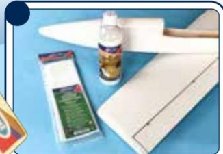
Po przycięciu tkaniny szklanej nakłada się drugą warstwę Eze-Kote. Po przeszlifowaniu i ewentualnym dodatkowym wypełnieniu model jest gotowy do malowania.
