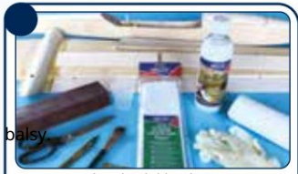
Eze-Kote z bardzo lekką tkaniną do laminowania z włókna szklanego o gramaturze 0,6 uncji (BD11), rękawiczkami, pędzlami i nożyczkami, które będą potrzebne do wykonania procesu Eze-Kote.
