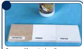
Po przeszlifowaniu skrzydła przetestowaliśmy podkład Halfords White i wybraną przez nas farbę Halfords Spray Ford Diamond White. Eze-Kote ma dobrą kompatybilność z większością białych lakierów samochodowych. Jeśli masz wątpliwości, zawsze sprawdź, testując podkład i warstwę wierzchnią przed przystąpieniem do modelu.
