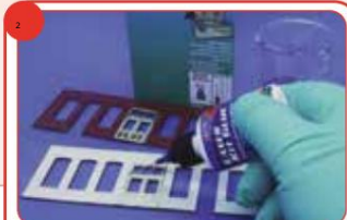
Wszystkie drzwi i okna można było łatwo skleić cienką warstwą kleju, który z łatwością przeniknął przez spoinę.
